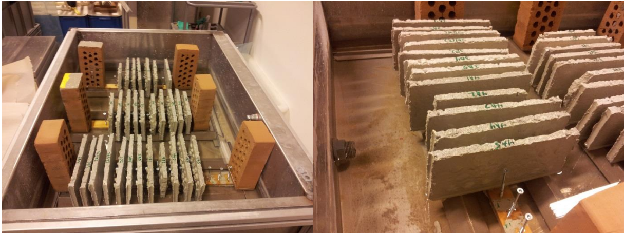
Figur 34 - Mørtelfuger i vannbad
