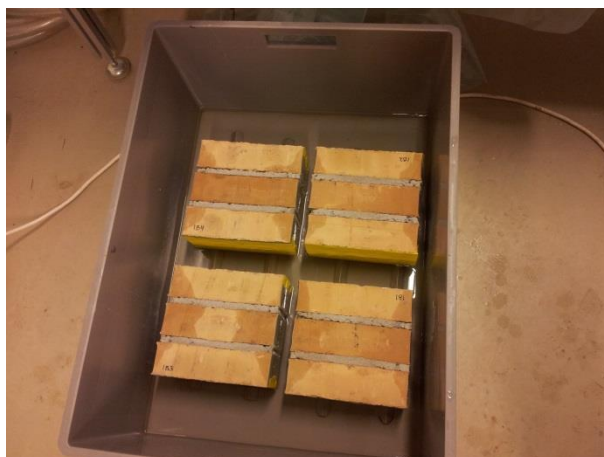
Figur 35 - Overflatefukt på pilarer mur med KC 50/50
