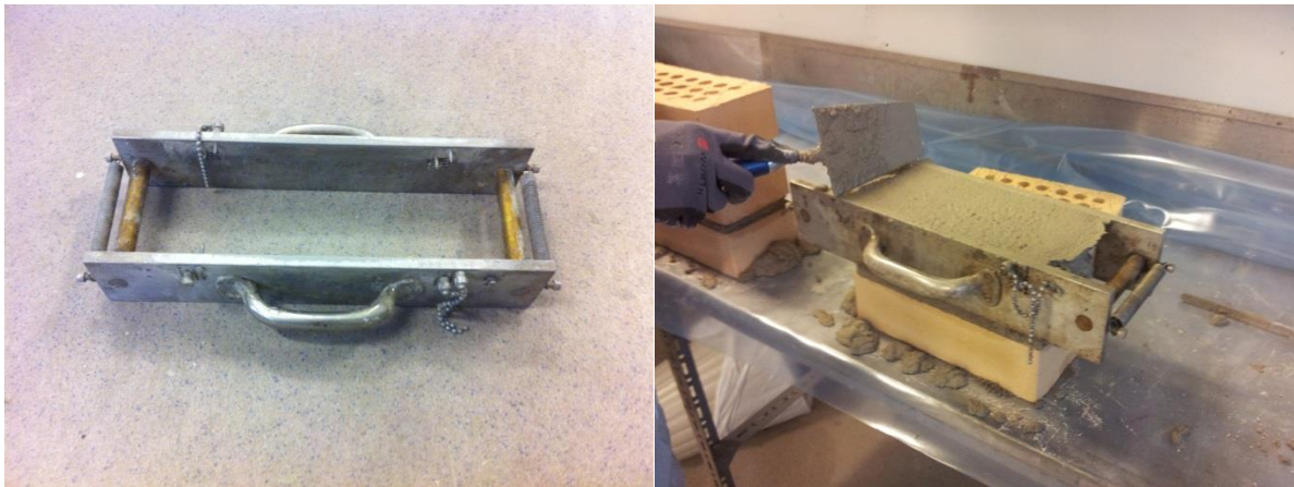
Figur 21 – Venstre: Aluminiumsform. Høyre: Muring med aluminiumsform
