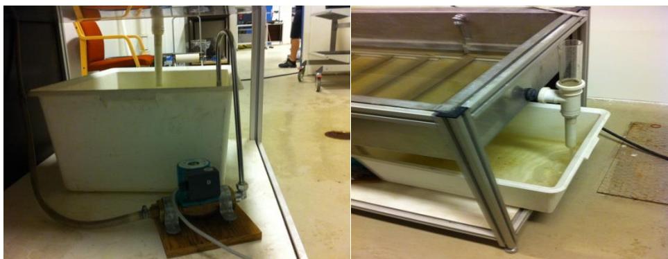
Figur 25 – Venstre: Vannkarets vannpumpe. Høyre: Dreneringssystemet til vannkaret
