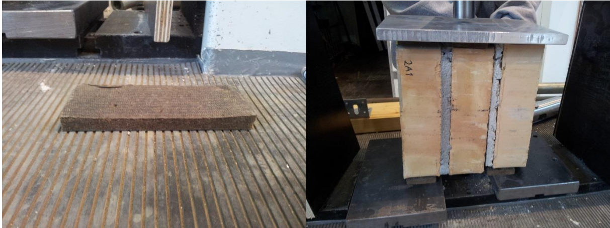
Figur 36 – Venstre: Trefiberplaten som ble brukt som mellomlegg i opplagerne. Høyre: Forsøksoppsettet i prøvemaskinen etter endt belastning med bruddtype B som resultat.
