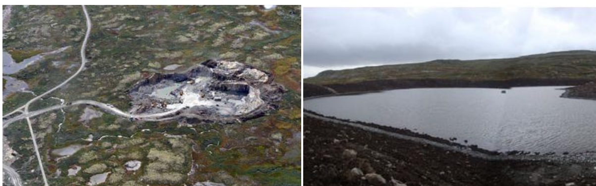
Figur 12: Steinbrudd under drift, og bruddtjern etter gjenfylling (foto: E-CO Energi AS).
