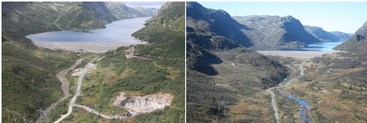
Figur 11: Steinbrudd under drift , høyre bilde viser samme område etter gjensåing (foto: Statkraft).
