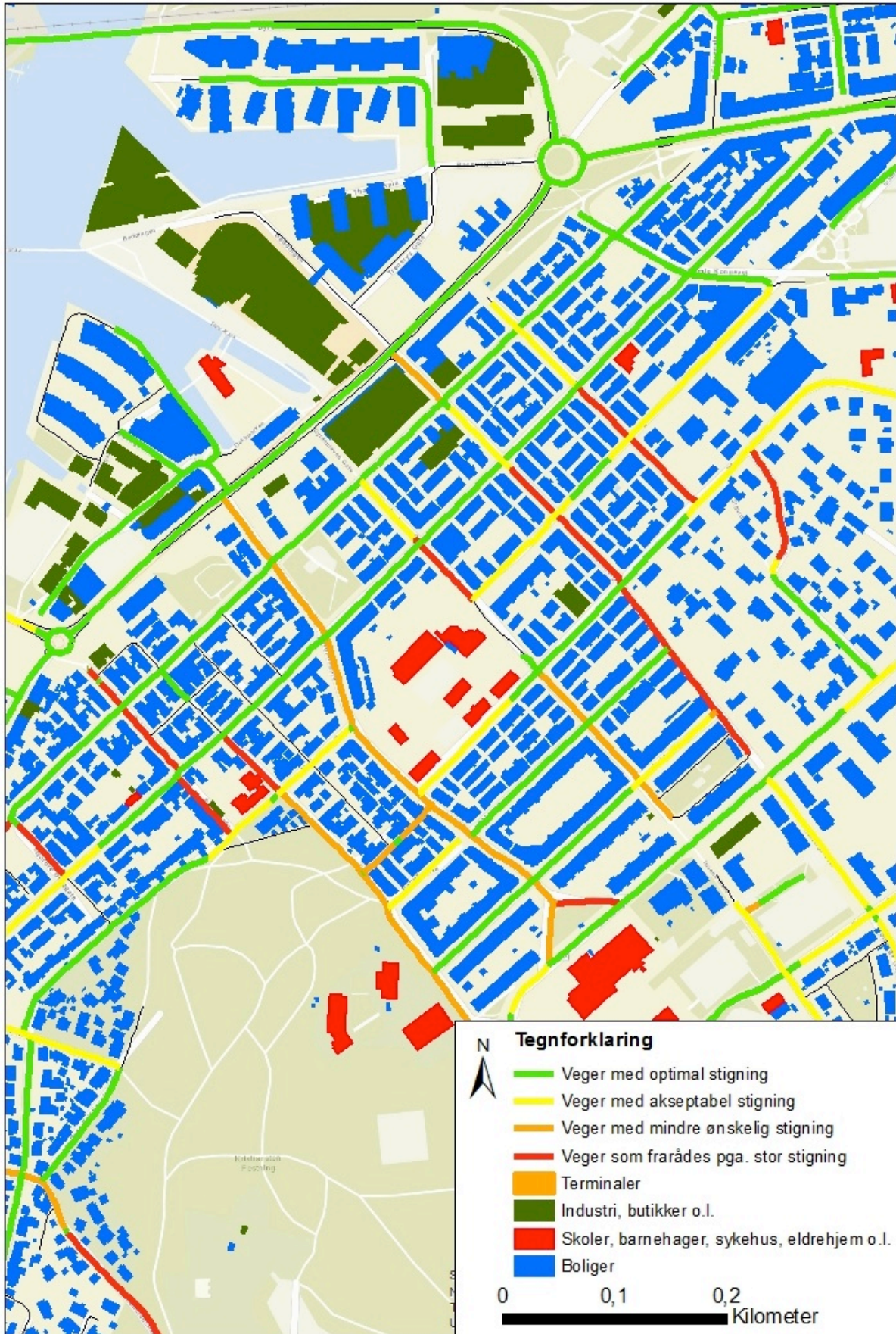
Figur 36: Ulike stigningsgrader og bygninger på Solsiden/Møllenberg/Rosenborg
