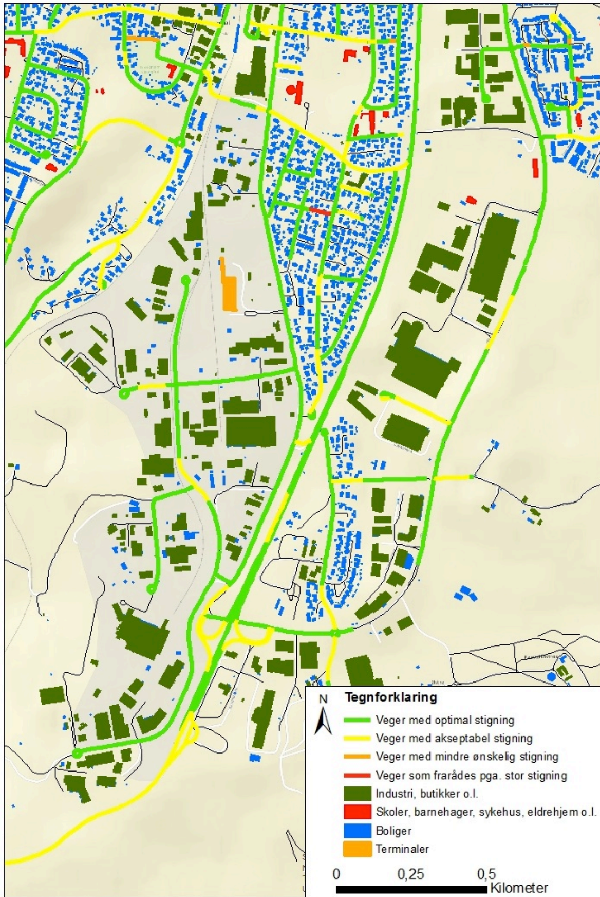
Figur 38: Ulike stigningsgrader og bygninger på Heggstadmoen
