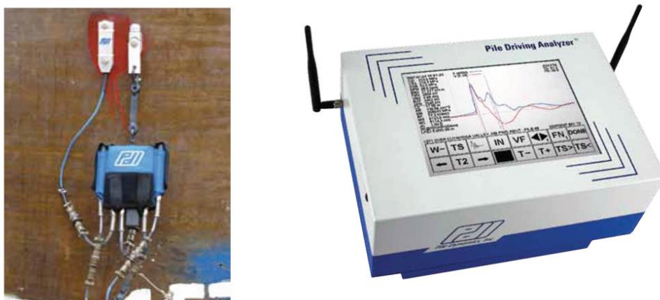
Figur 1 – PDA-måleutstyr for måling og av akselerasjon og tøyning. Bildet er kopiert fra Pile Dynamics Inc. sine hjemmesider (Pile Dynamics Inc., 2014).
