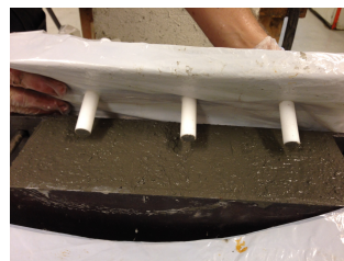
Fig. 3.2: Installering av plastpinner
