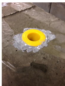
Fig. 3.6: Limt plugg for egenuttørking Fig. 3.7: Liming av plugg med folie
