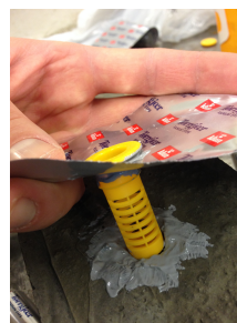
Fig. 3.6: Limt plugg for egenuttørking Fig. 3.7: Liming av plugg med folie
