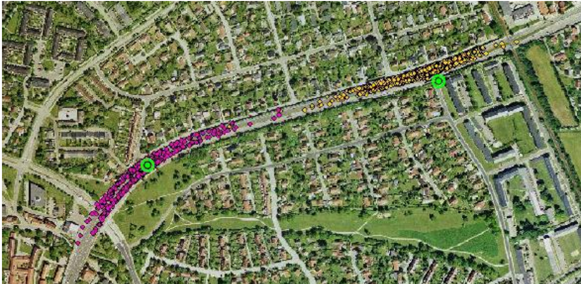
FIGUR 5 – FORDELING AV REGISTRERINGER FORETATT I DANMARK MED TO BLIPTRACK SENSORER (ARAGHI ET AL., 2013)
