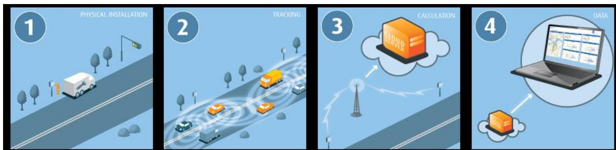
FIGUR 1 – FIRE GRUNNLEGGENDE PROSESSER FOR REISETIDSREGISTRERINGER VED BRUK AV BLIPTRACK (BLIP SYSTEMS, 2014)
