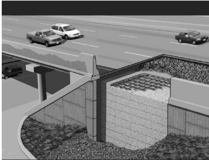
Figur 1-5. Landkar med Geofoam fylling (Utah Department of Transportation, 2000)
