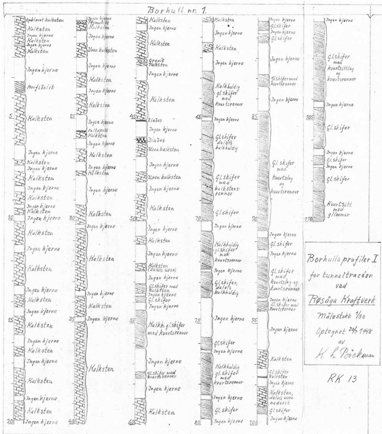
Figur 2: Beskrivelse av borehull bh1 utført i 1948. Legg merke til den stedvis hyppige vekslingen mellom bergartene. Legg også merke til at det var hyppig kjernetap. Dette er ikke nødvendigvis fordi det er dårlig berg, det kan også skyldes dårlig boreutstyr sammenlignet med dagens kjerneboremaskiner.
