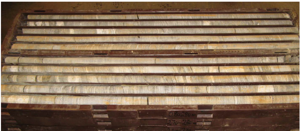
Figur 6: Eksempel på borekjerner (BOR 03) i kraftstasjonsområdet.
