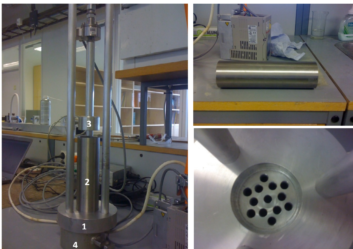
Figur 15 Bilde til venstre viser apparatet i sin helhet, mens bildene til høyre viser stålsylinderen (øverst) og den perforerte platen (nederst). Bokstavene på bildet angir (1) Stålplaten (2) Stålsylinderen (3) Stempelet (4) Skålen for oppsamling av omrørt leire
