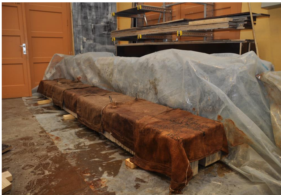
Figur 21 Oppbevaring av bjelker etter støping
