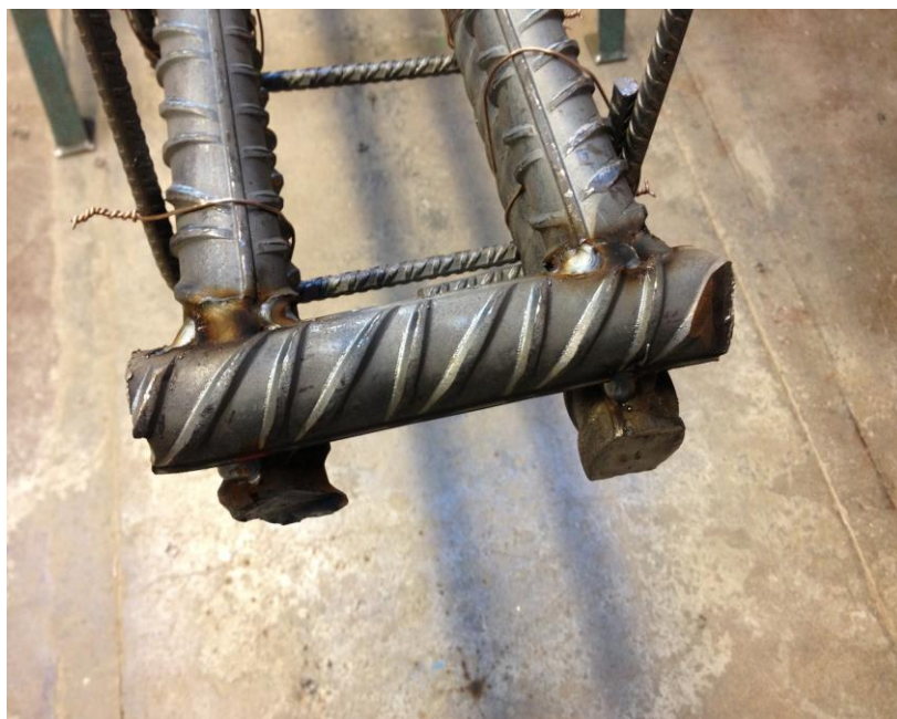
Figur 15 Endeforankring av lengdearmeringen
