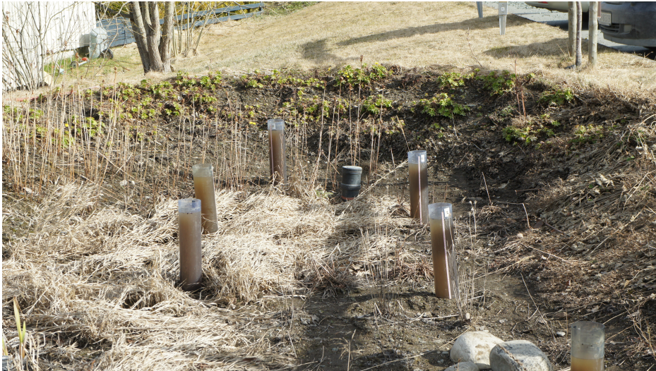
Figur 3.6: MPD-forsøk for måling av infiltrasjon i Risvollan regnbed.
