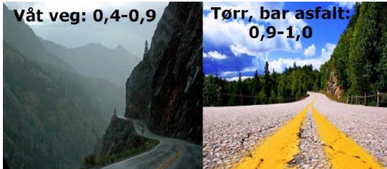
Figur 5-5 Friksjon på våt og tørr asfalt
