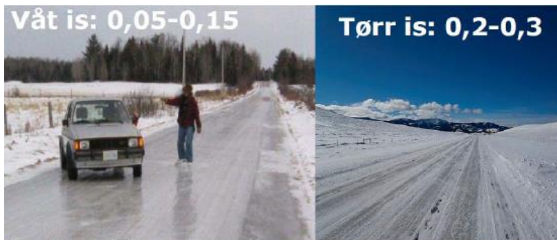
Figur 5-3 Friksjon på våt og tørr is
