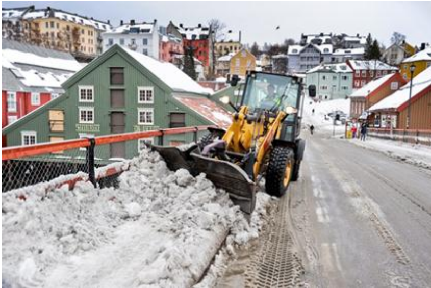
Figur 30 Brøytebil som skråkjører på grunn av for smalt fortau. Foto: Knut Opeide, Statens vegvesen.
