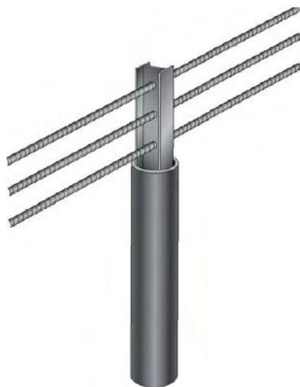
Figur 6 Wirerekkverk påmontert plasthylse. Kilde: Statens vegvesen, 2006a.
