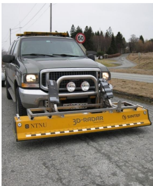
Figur 43 Bilde av georadar ved Malvikvegen.
