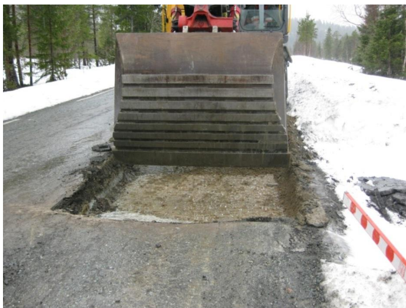
Figur 63 Oppgraving skjer lagvis slik at prøver kan tas fra ulike dybder.
