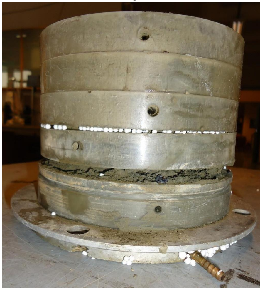
Figur 81 Prøve M3, viser tydelig telehivdannelse.
