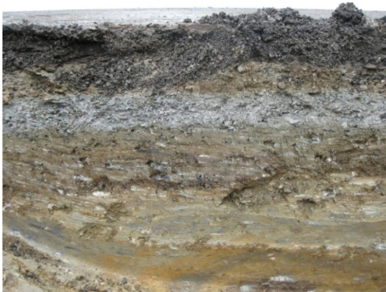
Figur 65 Tydelig lagdelt struktur i grunnen som kan øke telefaren.
