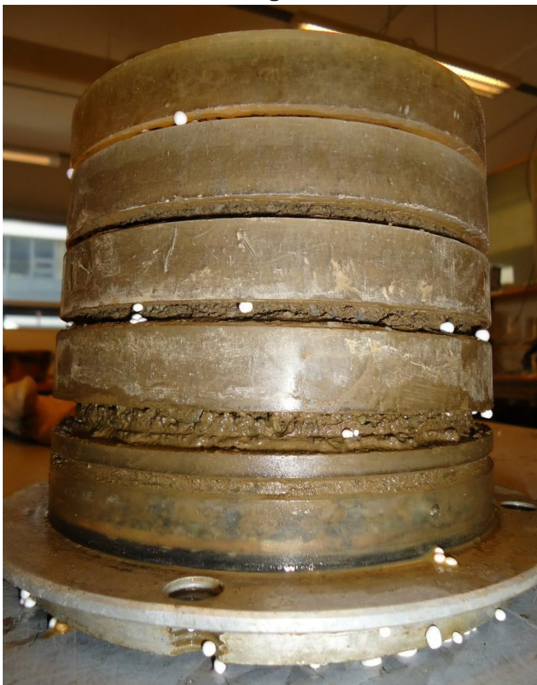
Figur 83 Prøve S2, viser svært tydelig telehivdannelse.
