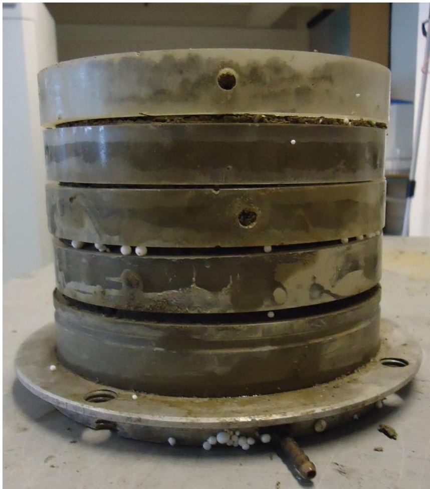
Figur 79 Prøve M2, viser tydelig telehivdannelse.
