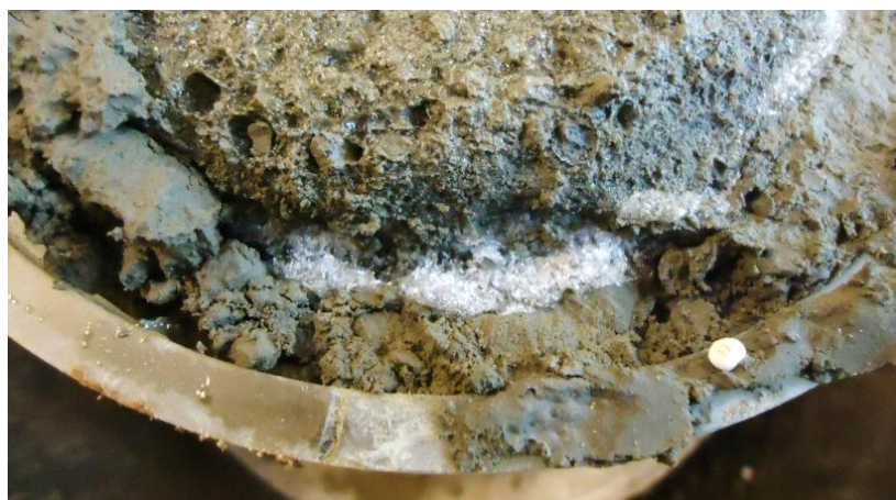
Figur 82 Nærbilde av islinsdannelse i prøve M3.
