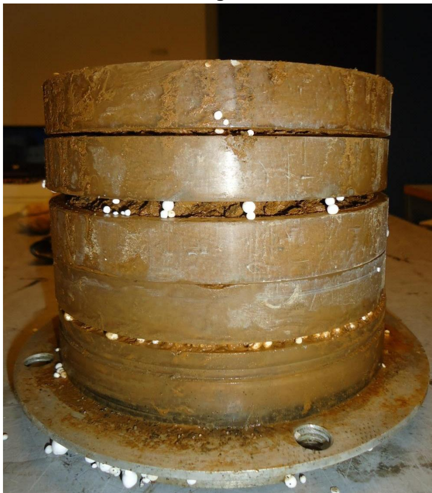
Figur 85 Prøve S4, viser svært tydelig telehivdannelse.
