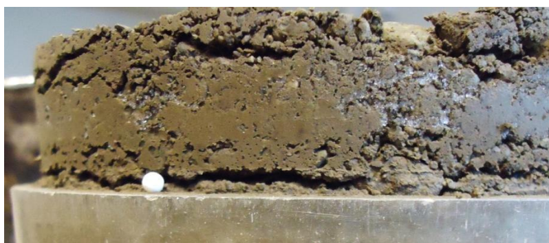
Figur 84 Nærbilde av islinser i prøve S2.
