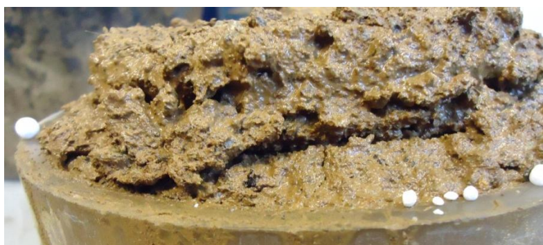
Figur 86 Nærbilde av prøve S4, også her var det tydelige islinser (utydelige på bildet pga smeltevann).
