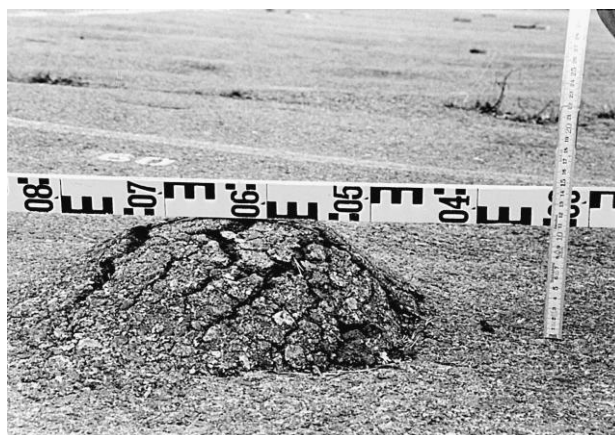
Figur 10 Løftet stein på asfaltert parkeringsplass, Luleå (Viklander og Eigenbrod, 2000, s. 152).
