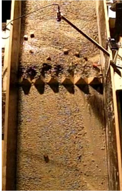
Figur 7.8: Masser liggende oppstrøms for kjebler i test 24 etter at skred har passert, foto: Fiskum (2012).
