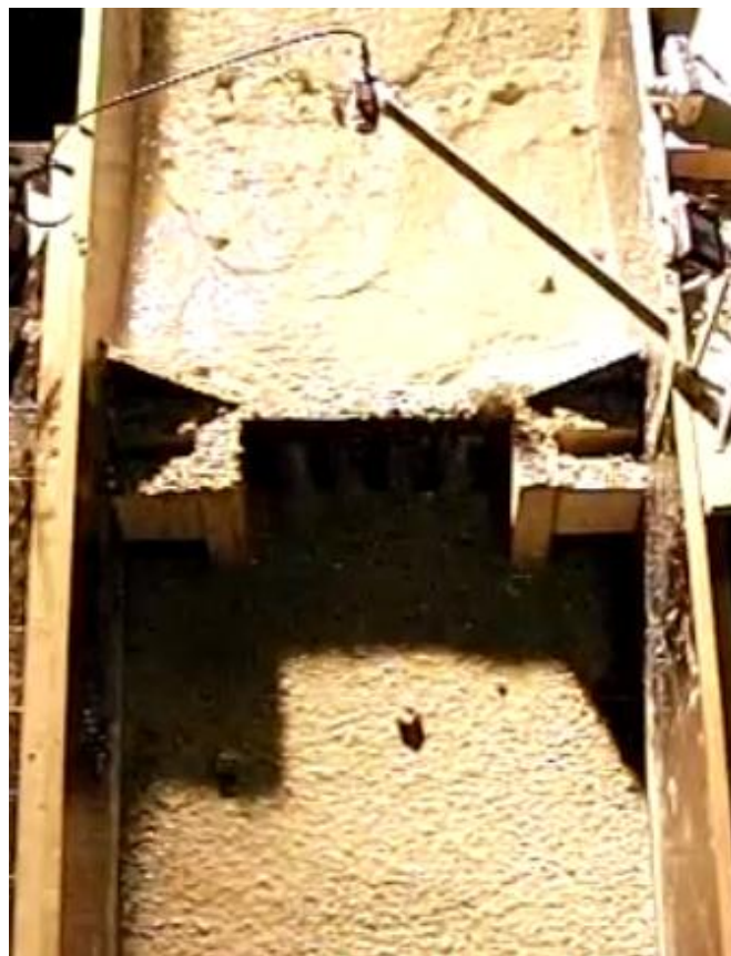
Figur 7.4: Masser som blir stoppet på oppstrøms side av 4-spalters kontrolldam, foto: Fiskum (2012).
