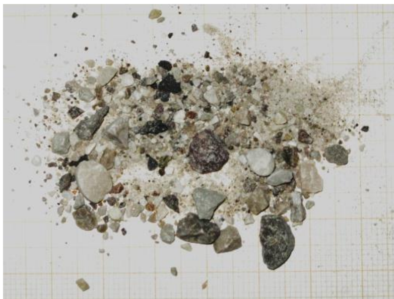
Figur 5.7: Skredmaterialet på millimeterpapir, figur Hiller og Jenssen (2009).
