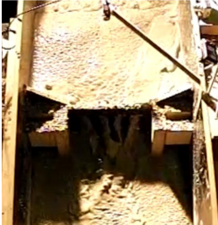
Figur 7.5: 4-spalters kontrolldam, massene flyter etter en stund gjennom spaltene på dammen. Foto: Fiskum (2012)
