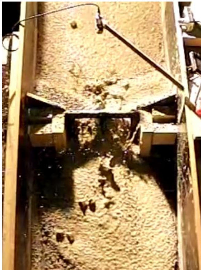
Figur 7.3: Masser som blir skylt opp på oppstrøms side av 2-spalters kontrolldam, foto: Fiskum (2012).
