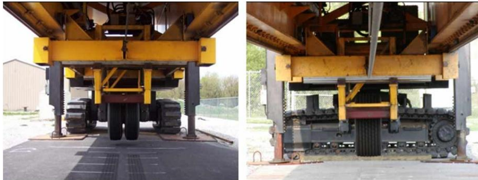
Bilde 12 ATLAS med et tvillinghjul (v) og med et bredanedekk (h). (AL-QADI, Imad L. et al., 2010)
