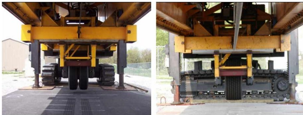
Bilde 12 ATLAS med et tvillinghjul (v) og med et bredanedekk (h). (AL-QADI, Imad L. et al., 2010)
