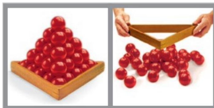
Bilde 2 En visuell beskrivelse av hvordan armering i granulære materialer fungerer. Uten triangelet kan ikke kulene stables på denne måten. (TENSAR, 2009)
