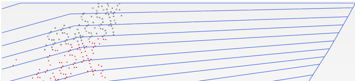
Figur 4-7: Plastiske punkt. Røde: Mohr-Coulomb punkt. Hvite: «tension cut-off» punkt
