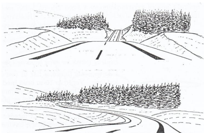
Figur 8 Bildene viser linjeføring som bryter opp landskapsformene og som understreker dem. Det siste er optimalt.
