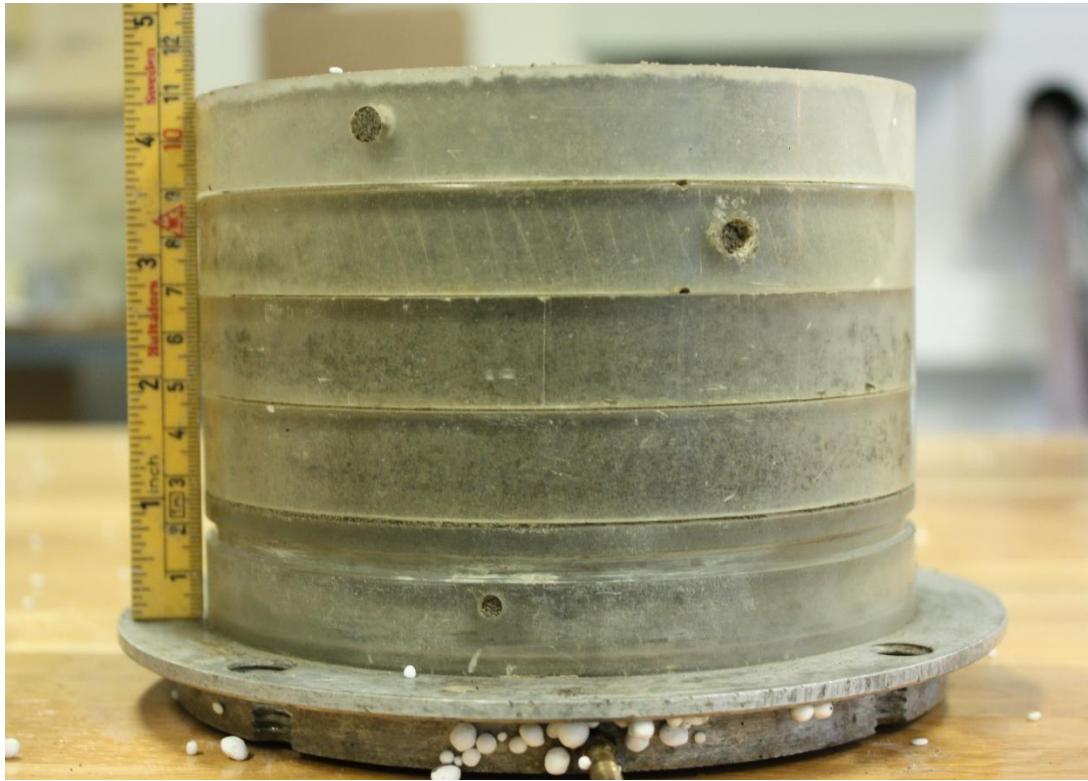
Figur 39 Bilde av prøve med 2,5 v- % saltinnhold etter frysning
