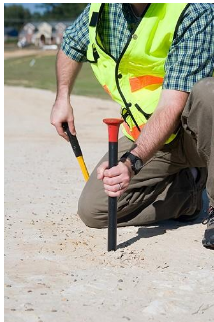
Figur 18 Frostpinne som blir slått ned i veg. Hentet fra Forestry suppliers (2012)
