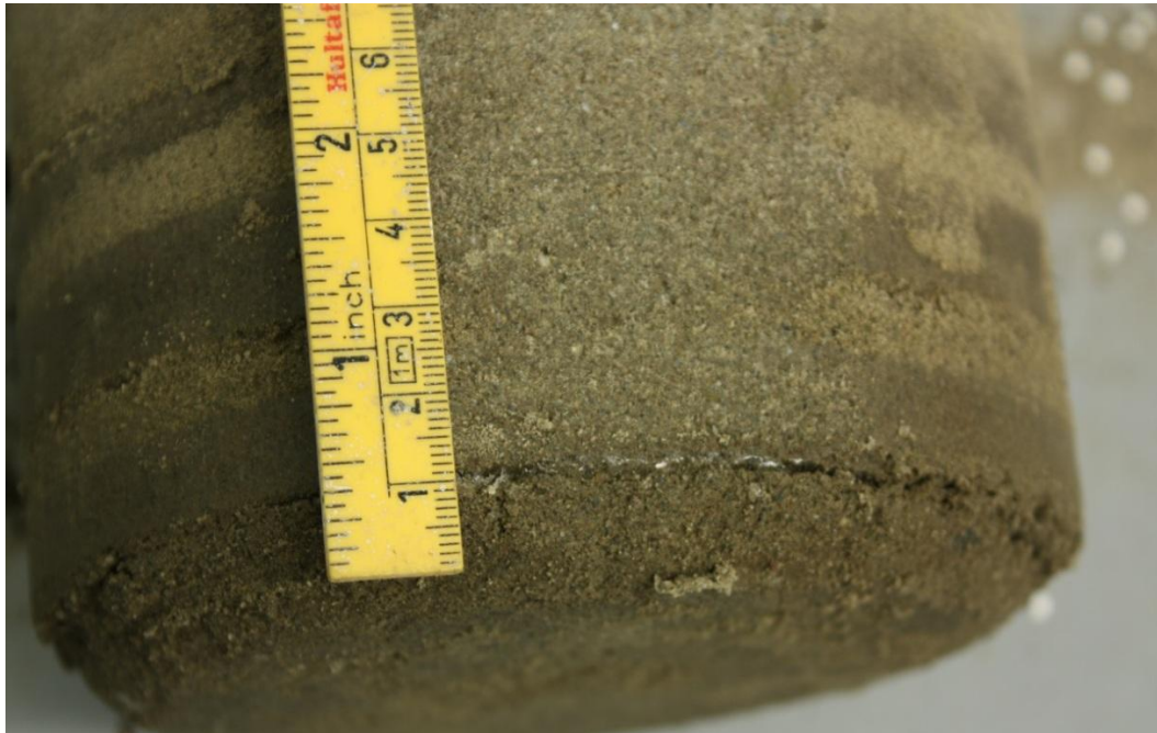
Figur 34 Islinsedannelse i bunn av prøve 1, forsøksserie 1.
