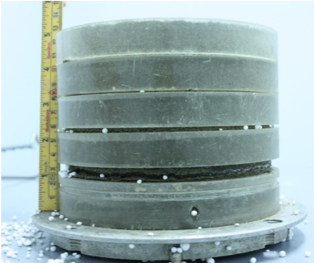
Figur 38 Islinse i Prøve 1, forsøksserie 2, ingen salt tilsatt.
