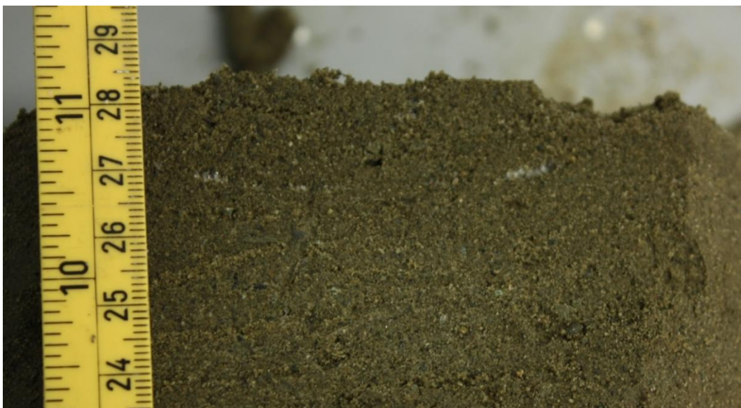
Figur 35 Islinsedannelse i topp av prøve 2, forsøksserie 1.
