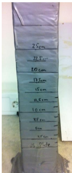
Figur 31 Nærbilde av boks som viser høyden platen slippes fra
