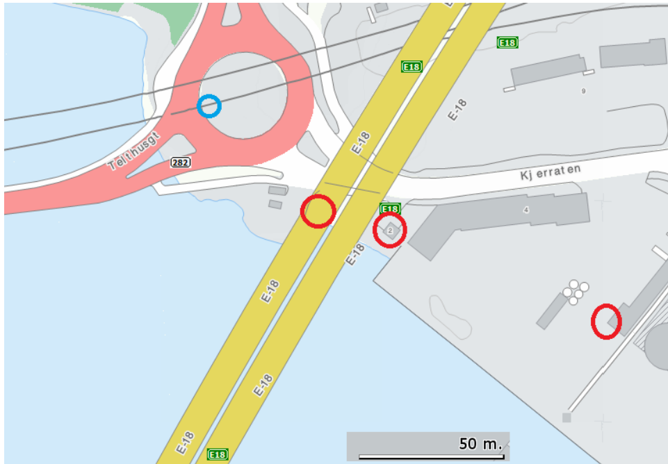
Figur 76 Plassering av vibrasjonsmålere ved Holmen
