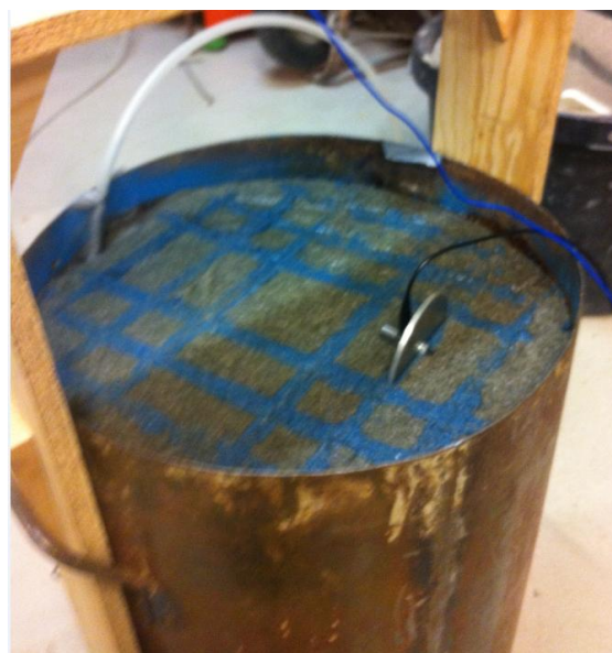
Figur 46 Akselerometerets plassering i overflaten
