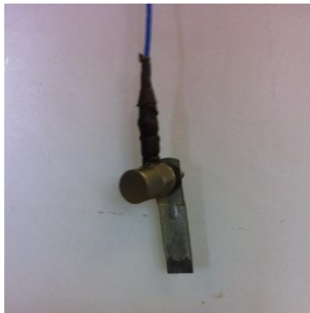
Figur 27 Akselerometer med pinne for å stabilisere det
