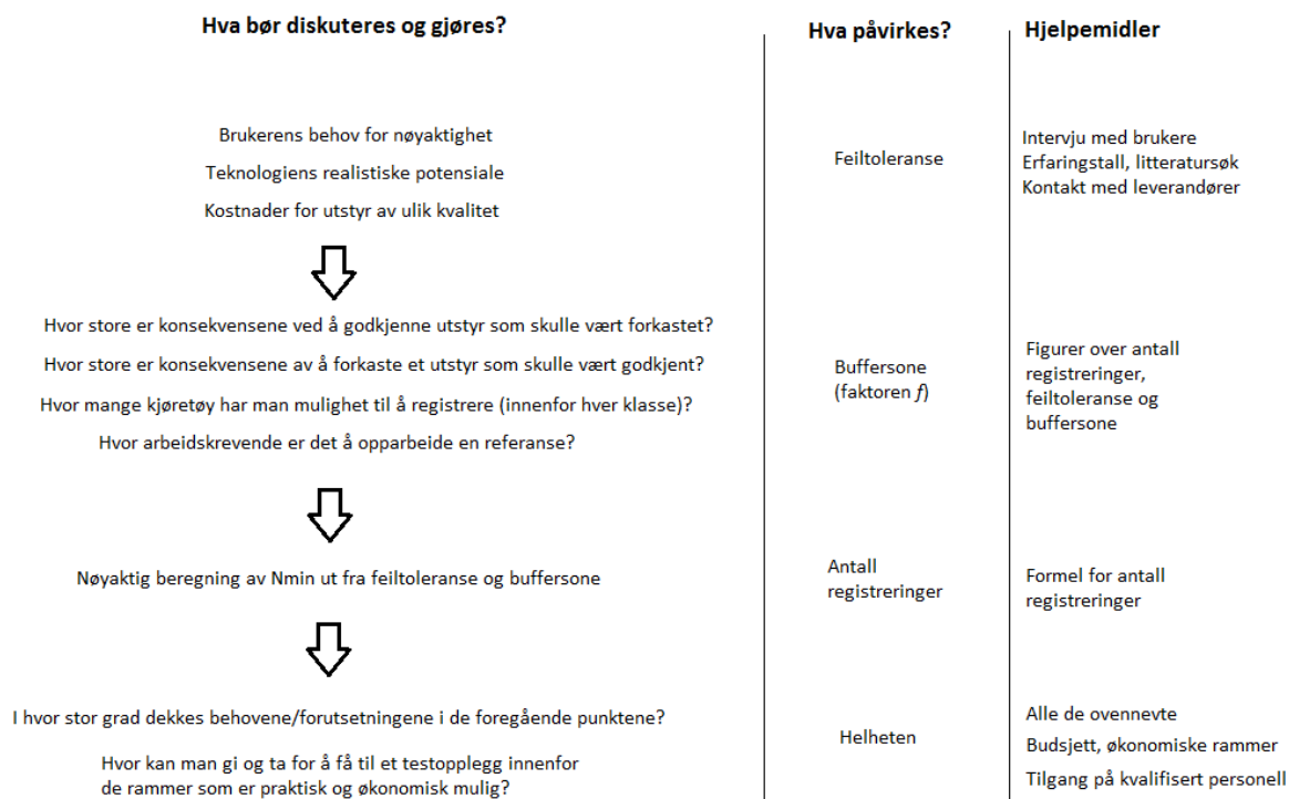
Figur 56 Flytskjema for vurdering av forutsetninger for testopplegg
