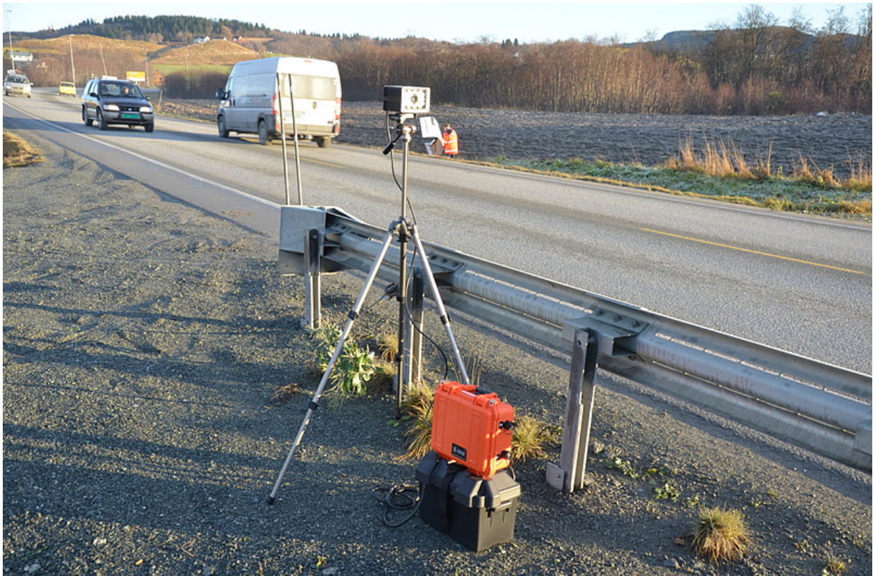
Figur 20 Automatisk nummerskiltlesning (ANPR) på E6 Klett. Foto Per Melen, Trafikverket
