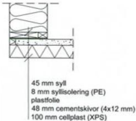
Figur 22 Vertikalsnitt av konstruksjon nr. 1. Kilde: (Olsson, 2011b).
