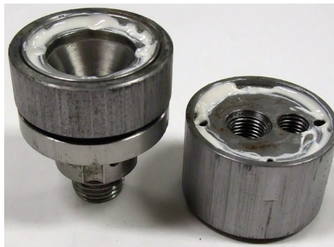
Figur 7.5.: Bruk av gjengetetting på mellomstykke og væskekammer
