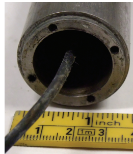
(a) Fra enden (med kabel for poretrykksensor)
