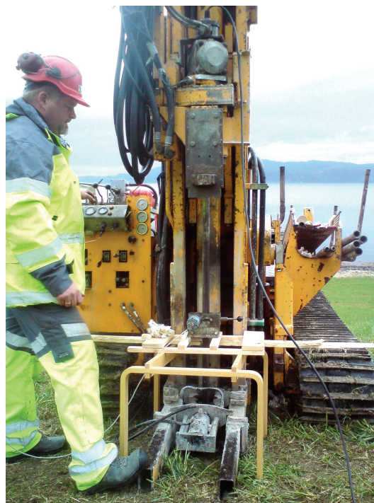
Figur 7.9.: Sondering og plassering av dybdemåler
