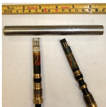
(a) Kabelskjøt adskilt
