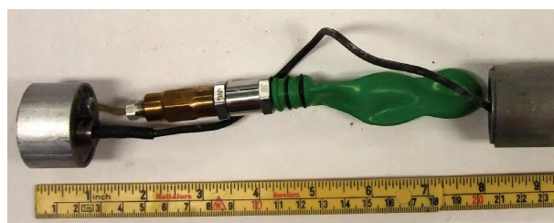
(a) Ventil og sensor festet til mellomstykke
