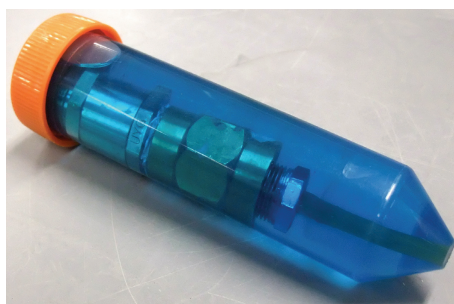
Figur 7.3.: Beholder for oppbevaring og transport av ventilats
