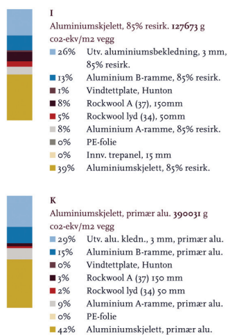
FIGUR 5: KLIMABELASTNING PR. KVM FOR TO YTTERVEGGER I ALUMINIUM.
