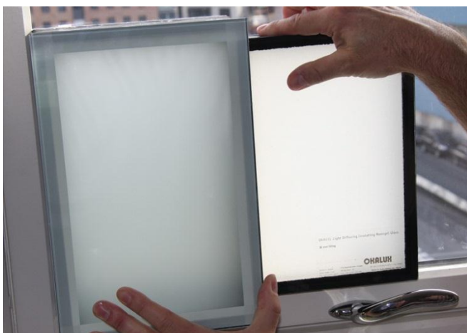
Figur 14 Qbiss Air til venstre, sammenstilt med en prøve med nanogel fra Ocalux.
