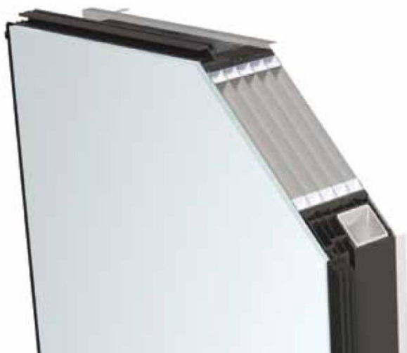
Figur 13 Oppbygning av Qbiss Air. Eksempel med 5 kamre, som også viser integrert bæresystem.
