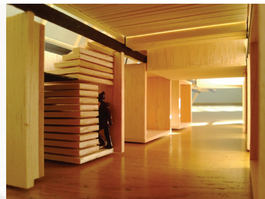
Vertikalforbindelsen er bygget inn i en funksjonsboks, og kan flyttes på samme måte som de andre boksene. Den inneholder en løfteplattform og en spiraltrapp bygget opp av lameller og lysspalter.
