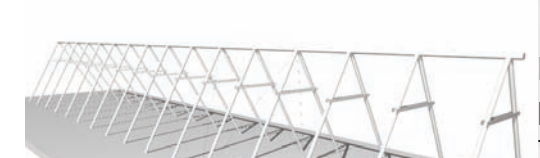
Bærebjelker av tre for modulene på plan 2 i en bypass-kobling til søylene med bulldog og gjennomgående bolter.
