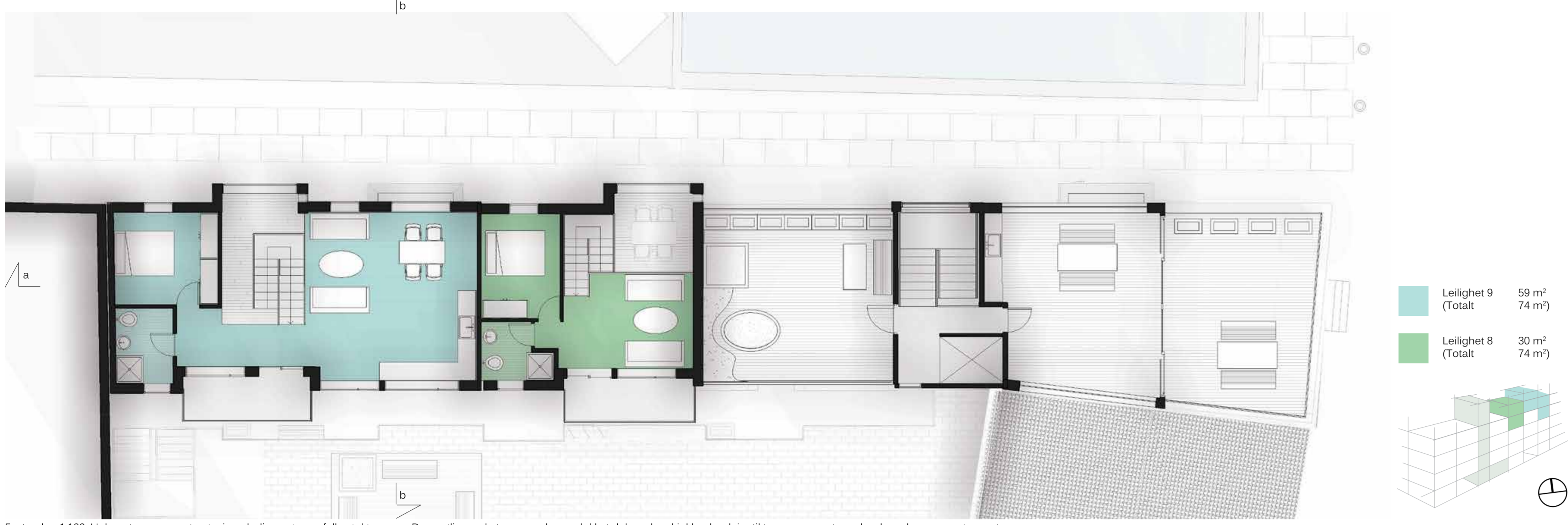
5. etg plan 1:200. Partiet av øverste etasje er bolig, resten er felles terrasse. Den anngående terrassen har en lukket del med en kjøkkensenk innv. oppganger og glassvegger og resten er terrasse.
