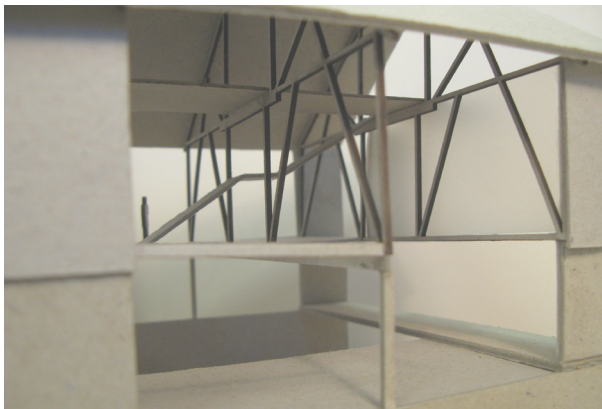
Skissemodell 1:100 - åpen fasade og lukket tak, trapp opp til lævebru, halvtransparent materiale på side for å gi et mer åpent uttrykk.
