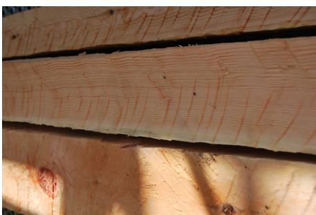
Sprettelgja stokkar til bruk i istandsettinga av Undredal stavkyrkje i 2012, utført av Nedre Jølster Bilelag. Bilelaget var òg involvert i middelalderprosjektet.
