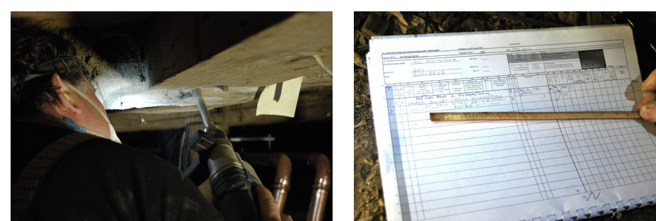
Her held Jan Michael Stormes frå NIKU på å ta ut boreprøve frå ein grunnstokk i Gol stavkyrkje. Dendrokronologisk boreprøve (Ø 7 mm) og skjema om prøvene for innsending til analyse.
