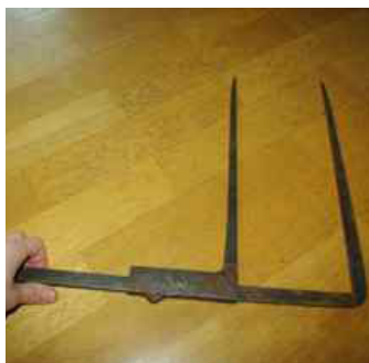
Veggtykkelse målt med tømmermåler og tommestokk
