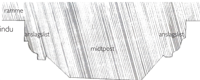
23. Midpost gammelt vindu, med flyttede anslagslister pga varevindu
