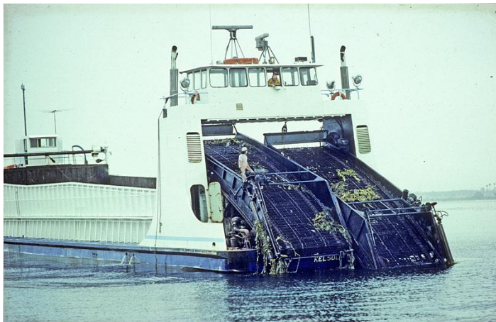
Fig. 2.5. Høsting av kalifornisk kjempetare utenfor St.Barbara, California i 1977. Fartøyet rygger gjennom tarefeltet som kuttes ved et dyp på ca. 2 m og føres om bord med transportbånd. (Foto: Mentz Indergaard.)
