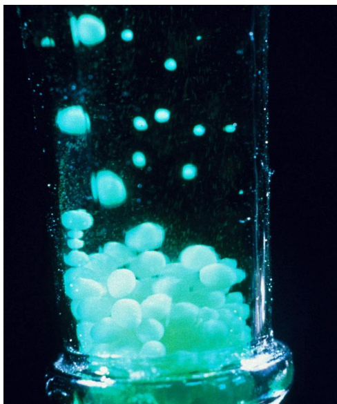
Fig. 6.9. Siste trinn i produksjonen av champagne er ettergjæring. Når den er ferdig må en få gjærcellene ut. Innstøpt i alginatkuler faller gjærcellene fort ned mot flaskeåpningen hvor de kan frysas, tas ut og flaska forsegles med den endelige korken. (Foto: Mentz Indergaard.)
