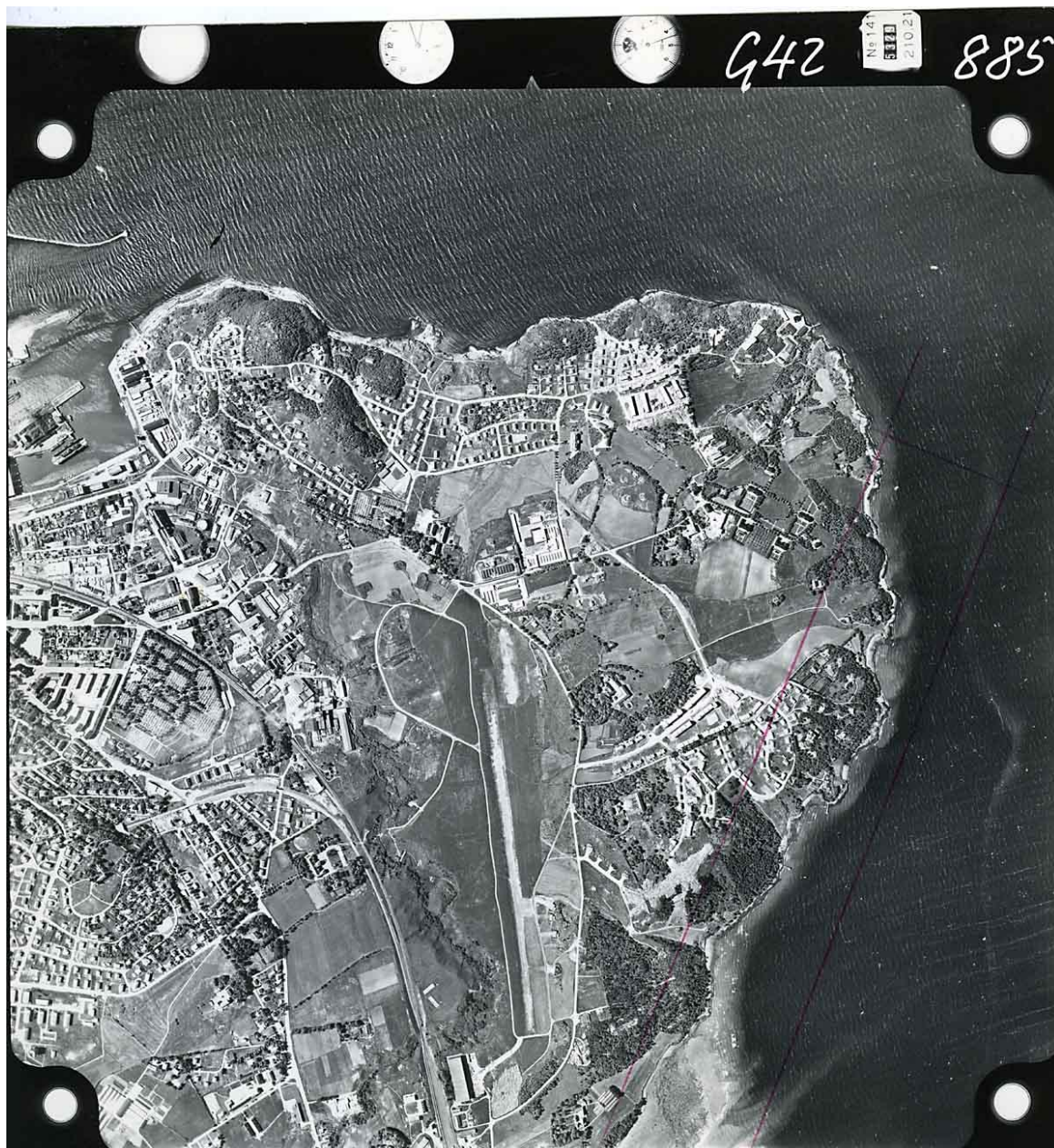
Fig. 2.6. Test av flyfotografering for kartlegging av tang- og tareressursene tidlig på 1950-tallet. Her fra Østmarkneset, Trondheim. En kan skjønne at bare litt urolig sjø kunne skape problemer med å se konturene til plantefeltene. Instrumentavlesninger (her sannsynligvis tid og høyde, samt serienr.) ble kopiert inn i overkant av bildet.
