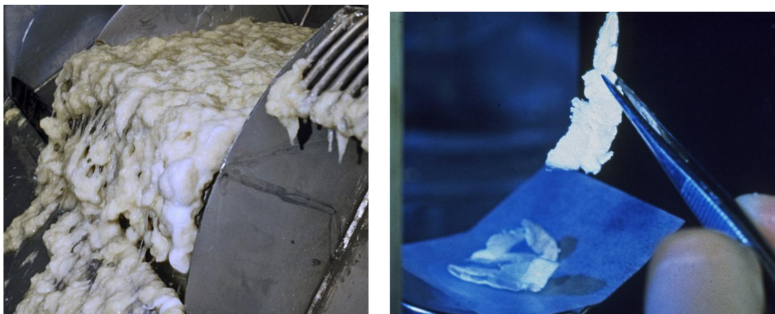
Fig. 7.2 a)–b). Industriell fremstilling av alginat. Fra et fellingstrinn i alginatfabrikken (Pronova Biopolymer) utenfor Haugesund på 1980-tallet (a). Utveiling av tørt, frysetørket alginat i labskala (b). (Foto: Mentz Indergaard.)
