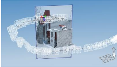
Figur 6 – Plassering av kamera ved fotogrammetri
