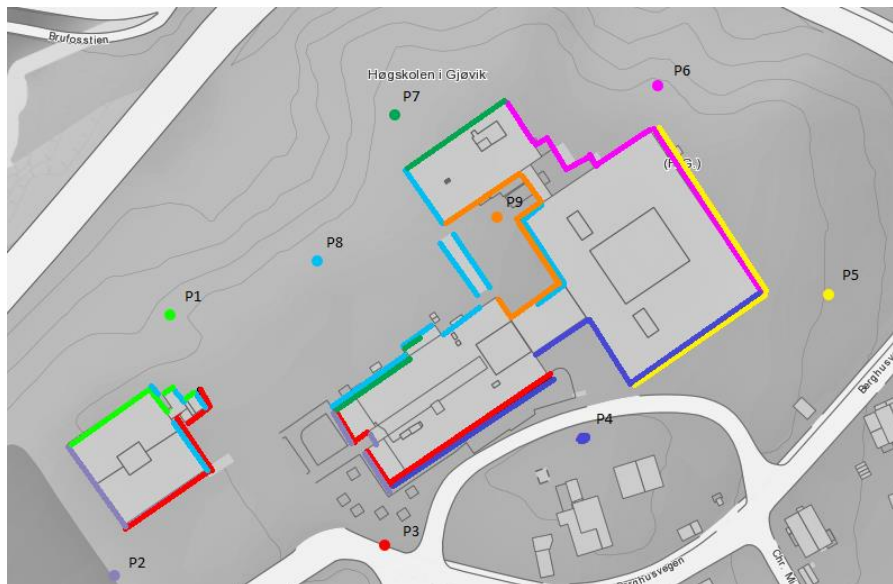
Figur 15 – Måleplan. Px er oppstillingene våre. Vi har gitt hver oppstilling fargekode, samt at det er mulig å se hvilke skann som vil dekke hvilke overflater.
