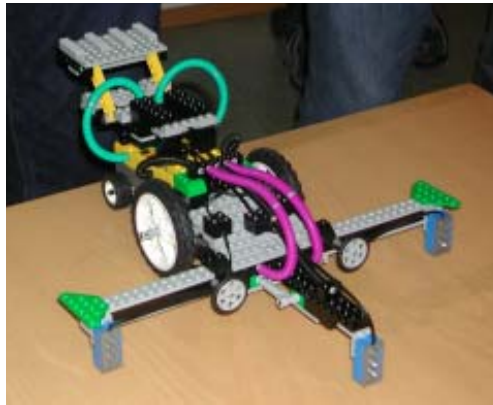
Figur 3-6 Rally-løp, Roboten har tre lyssensorer som registrerer om den er over bordet eller gulvet.
