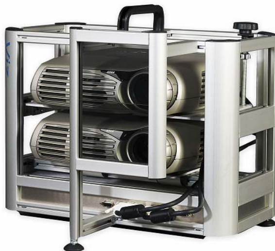
Figur 4.1.2 Prosjektører med ramme, polarisasjonsfiltre og converterenhet
