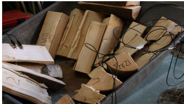
Bilde 2. Merkede vedkubber med noen påmonterte elektroder
