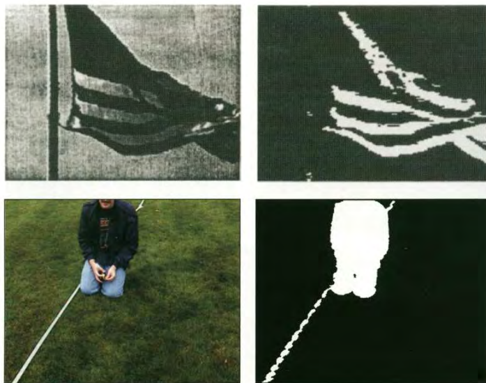
Figur 10: Bildet øverst til venstre viser et sort hvitt bilde av et flagg. Øverst til høyre har det blitt generert en maske av dette bildet der alle segmenter med hvit farge er maskert. I bildet nederst til høyre er det generert en maske av fargebildet nederst til venstre. Alle fargene bortsett fra grønt er maskert [15].
