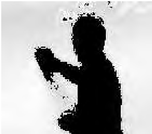
Figur 39: Masken inkluderer noen små områder inne i personens kontur. Dette vil bli støy etter segmentering
