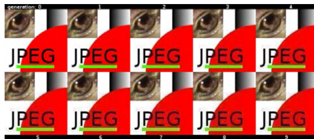
Figur 24: Bildet viser hvordan kvaliteten reduseres for hver gang bildet regenereres i JPEG kvalitet. Kvalitetsreduksjonen synes spesielt godt i røde og grønne områder [61]
