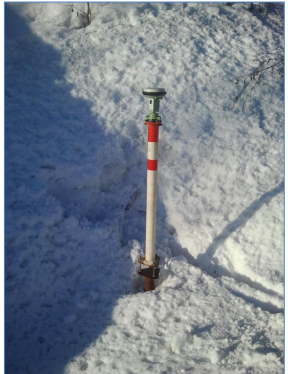
Figur 6: En oppvatret søyle på Åsta- anlegget.
