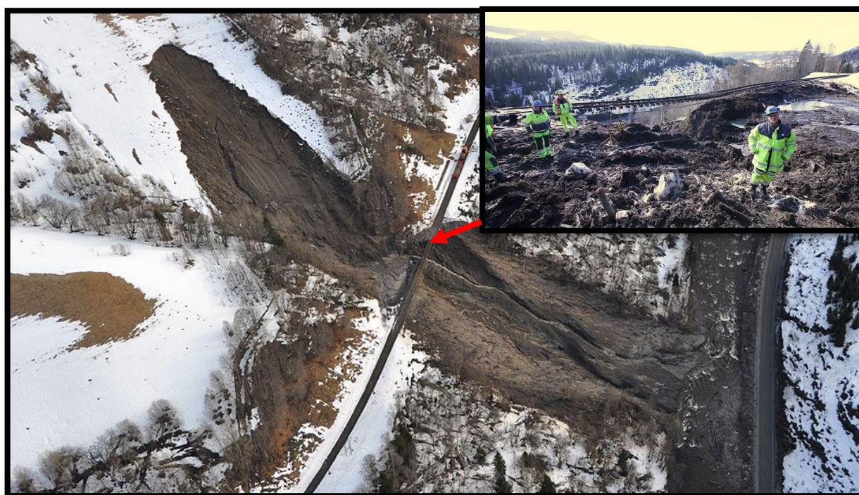
Figur 6 - Oversiktsbilde over raset i Soknedal, Sør-Trøndelag, og ødeleggelse på skinnegang (innfelt i høyre hjørne).
