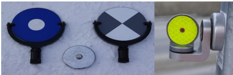
Figur 18 – Viser de ulike targets brukt under innmålingene, samt plattformen.
