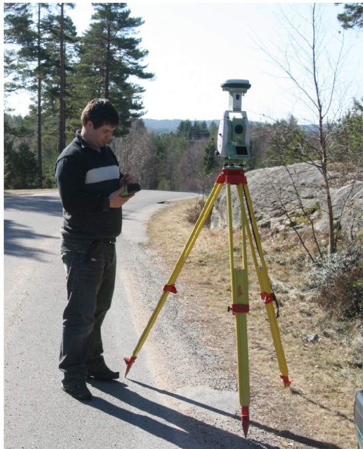
Figur 8: Oppstilling av Leica SmartStation i testområde
