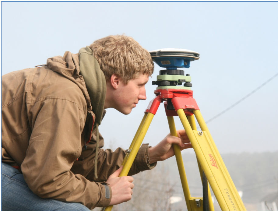
Figur 9: Oppstilling av base til Mobile Mapper
