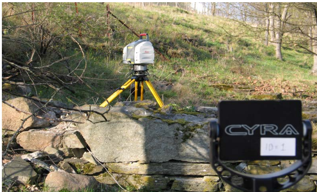
Bilde 46) viser en laserskanner og en targets som er av gjenkjenlig type
