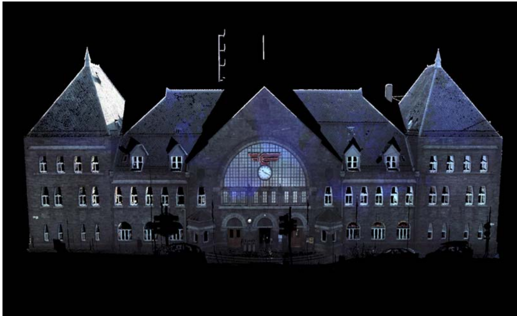
Laserskannings bilde11) som brukes i forbindelse med kartlegging av bygning
