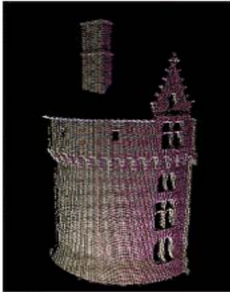
Bilde 9) viser eksempler på oppmåling med bakkebasert laserskanning både innendørs og utendørs.
