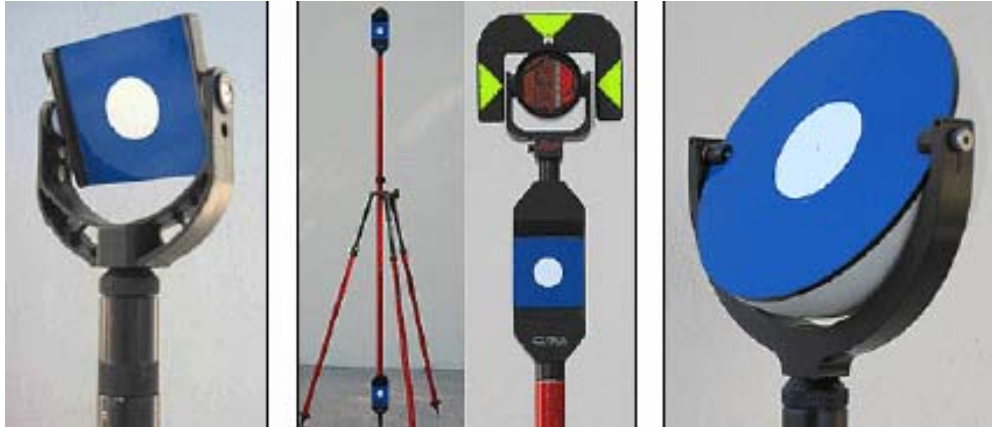
Bilde34) Forskjellige typer av Cyra targets(kvadratisk, tvilling targets og sfærisk)
