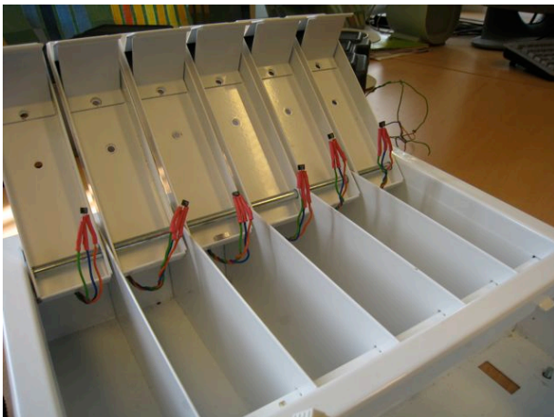
Figur 4.3a Hall-effekt sensorer, før endelig montering
