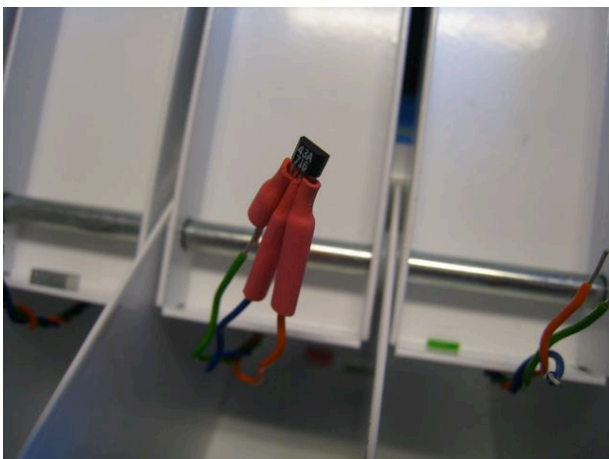
Figur 4.3c Hall-effekt sensor, før endelig montering.
