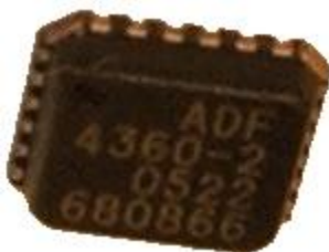
Figur 13: ADF 4360-2 Integrert frekvenssyntetisator og VCO/lokaloscillator
