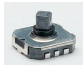
Figur 4: Joystick på fjernkontrollen
