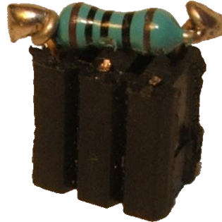
Figur 26: Reset-jumper slik den ser ut innvendig
