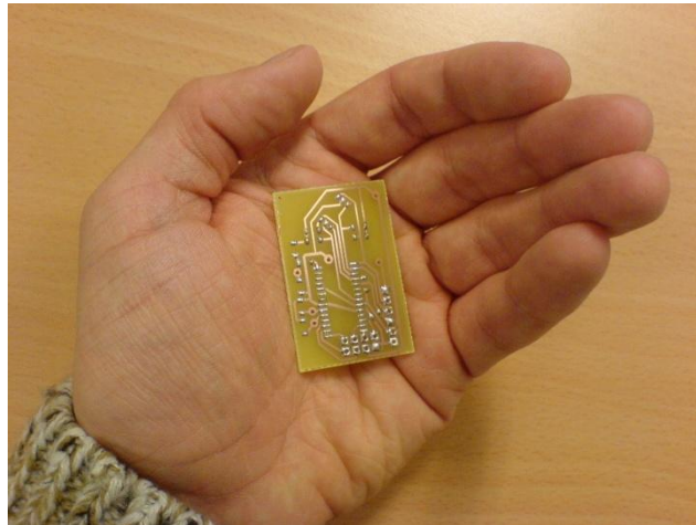
Figur 16: Første utgave av kretskortet til fjernkontrollen
