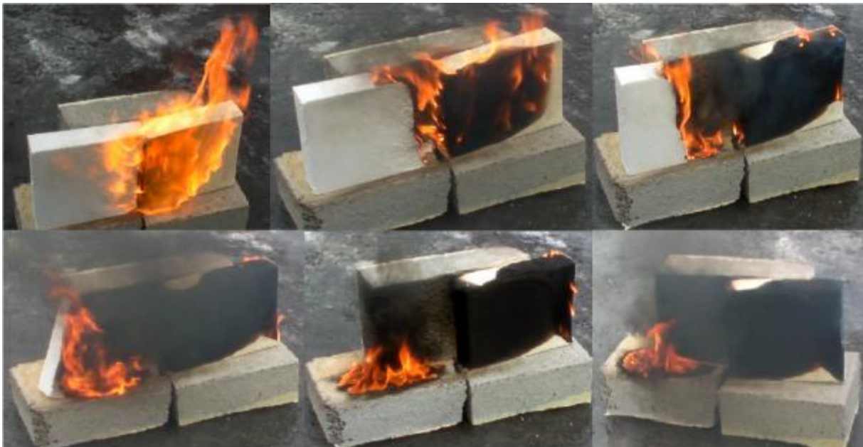
Figur 10 Fullstendig brannforløp av en liten prøve med EPS og PUR, illustrasjon Bjerke
