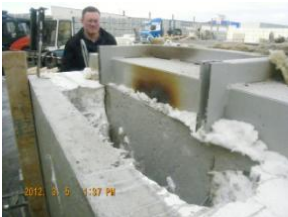
Isolasjonen har smeltet bort (65 min) forsøket ble avsluttet like etterpå
