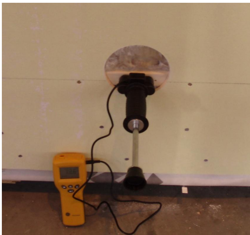
Bilde 1 : Bilde av protimeter MMS med hammerslagselektrode
