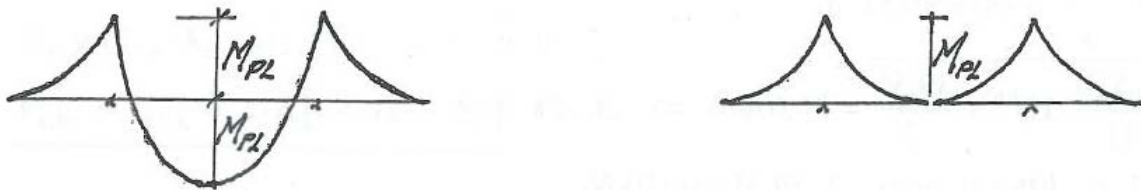
Figur 5.3-1 Illustrasjon av effekten ved å kappe en dybel (Fallsen, Stavdybler, 2010)
