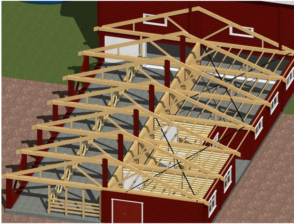
Figur 32 viser avstivere (sorte) over undergurt
