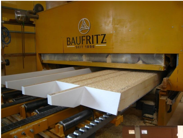
Maskinen presser kutterflisen inn i det prefabrikkerte veggelementet.
