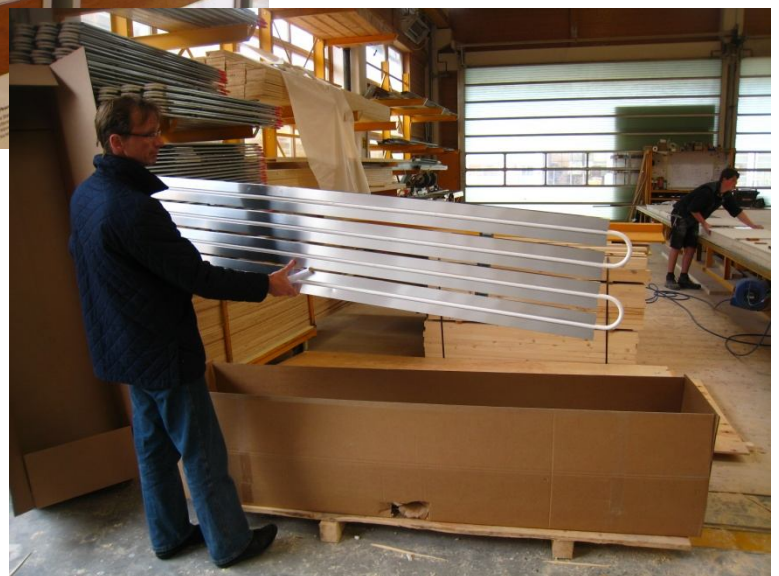
Vannbåren varme i veggene bidrar også til at mysen I kutterflisen varmes opp slik at brannsikkerheten heves.
